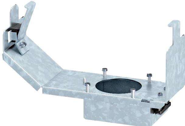
Geräteträger der Nenngroße 3 für den Einbau einer CEE-Steckverbindung 16 A oder 32 A zum Einbau in Geräteeinsätzen und Kassetten der Nenngroße R7, 9 und R9. Geräteträger mit Schutzgehäuse und Zugentlastung. Benötigte Mindesteinbautiefe: 190 mm bei Verwendung eines Geradeaus-Steckers und 160 mm bei Verwendung eines Winkelsteckers.
