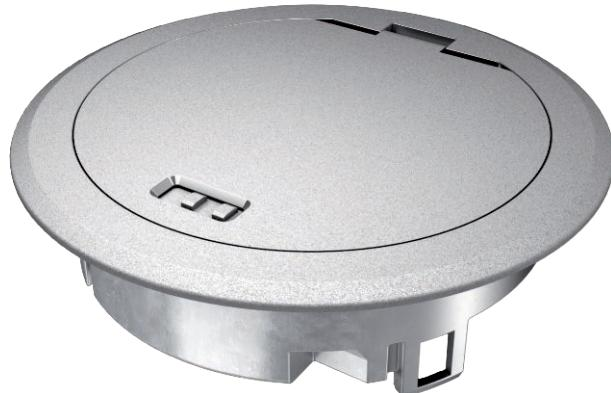
Geräteeinsatz mit Klappdeckel und Rastschieber für Bodensteckdose GES R2 zum direkten Einbau in die Installationsdose MT R2 im Innenbereich.
