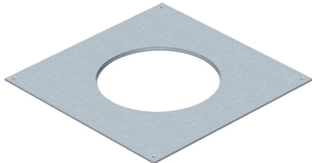
Montagedeckel für Unterflur-Zug- und -Abzweigdosen vom Typ UZD350-3 zum Einbau einer Einbaueinheit der Nenngröße R4. Einbauöffnung 3 mm vertieft zum nachträglichen Blindverschluss mit Deckelblindplatte.
