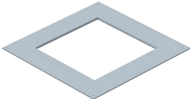
Montagedeckel für Unterflur-Zug- und -Abzweigdosen vom Typ UZD350-3 zum Einbau einer Einbaueinheit der Nenngröße 9. Einbauöffnung 3 mm vertieft zum nachträglichen Blindverschluss mit Deckelblindplatte.
