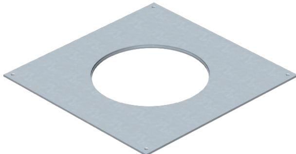
Montagedeckel für Unterflur-Zug- und -Abzweigdosen vom Typ UZD250-3 zum Einbau einer Einbaueinheit der Nenngröße R4. Einbauöffnung 3 mm vertieft zum nachträglichen Blindverschluss mit Deckelblindplatte.
