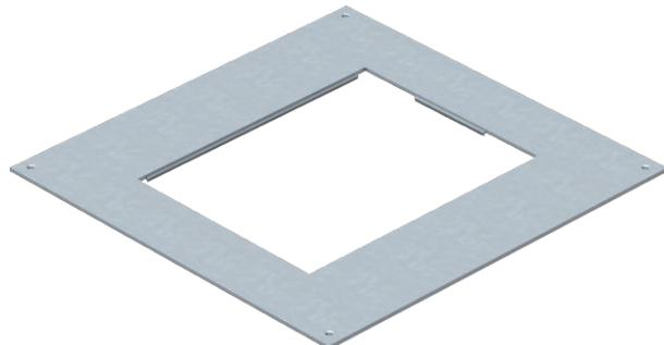
Montagedeckel für Unterflur-Zug- und -Abzweigdosen vom Typ UZD250-3 zum Einbau einer Einbaueinheit der Nenngröße 6. Einbauöffnung 3 mm vertieft zum nachträglichen Blindverschluss mit Deckelblindplatte.
