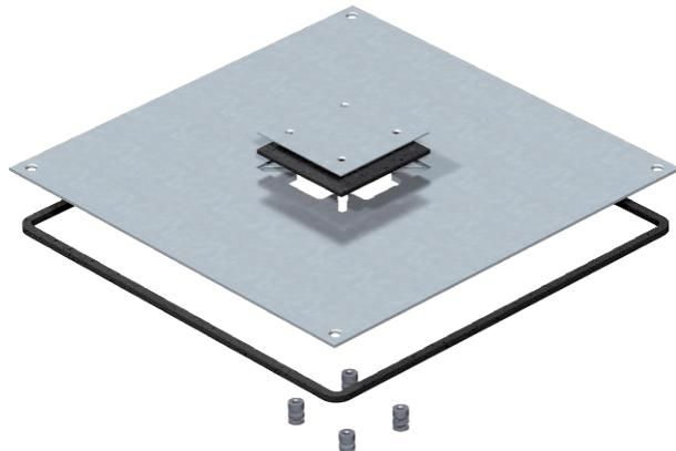
Montagedeckel für Unterflur-Zug- und -Abzweigdosen vom Typ UZD350-3 zum Aufbau eines Telitanks. Einbauöffnung 3 mm vertieft zum nachträglichen Blindverschluss mit Deckelblindplatte.
