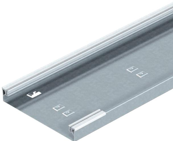
Aufflur-Installationskanal-Unterteil, 1zügig, für Blind-/Montagedeckel mit einseitiger Abschrägung, mit aufsteckbaren Aluminium-Seitenprofilen zum Auflagern und Befestigen der Kanaldeckel, Bodenwanne mit Halteschalen für max. 2 einsteckbare, selbstkontakterende Trennstege und Prägung für Schutzleiteranschlusswinkel. Kanalhöhe geeignet zum Einbau von Geräteeinsätzen der Nenngröße 2.
