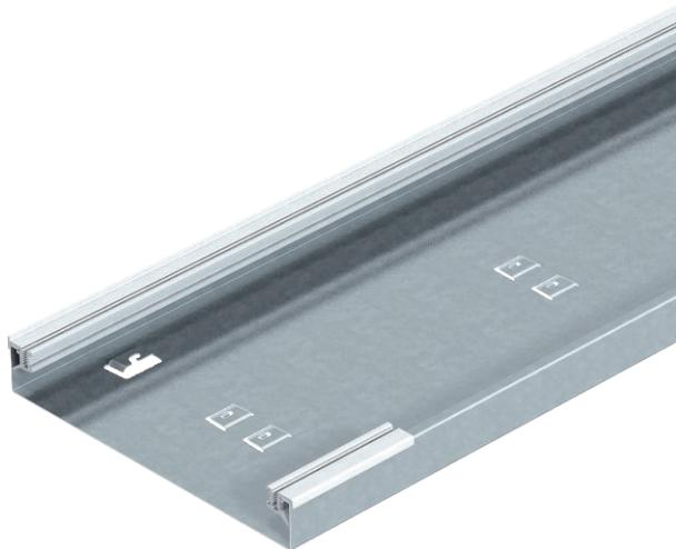
Aufflur-Installationskanal-Unterteil, 1-zügig, für Blind-/Montagedeckel mit einseitiger Abschrägung, mit aufsteckbaren Aluminium-Seitenprofilen zum Auflagern und Befestigen der Kanaldeckel, Bodenwanne mit Haltelaschen für max. 2 einsteckbare, selbstkontakterende Trennstege und Prägung für Schutzleiteranschlusswinkel. Kanalhöhe geeignet zum Einbau von Geräteeinsätzen der Nenngröße 2.
