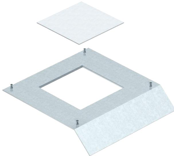
Geräteeinsatzdeckel für Kanalunterteil AIK/U für den Einbau eines Geräteeinsatzes der Nenngöße 4. Montageöffnung durch 2-mm-Alu-Blindplatte verschlossen. Der Kanaldeckel wird in den Al-Seitenprofilen des Kanalunterteils festgeschraubt. Die Deckelschräge übertragt das Kanalunterteil im 45°-Winkel.
