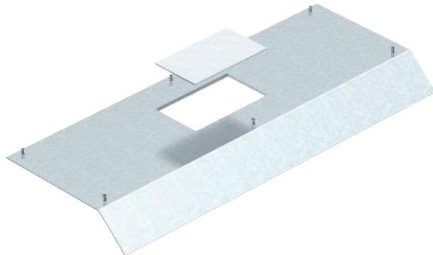
Geräteeinsatzdeckel für Kanalunterteil AIK/U für den Einbau eines Geräteeinsatzes der Nenngöße 2. Montageöffnung durch 2-mm-Alu-Blindplatte verschlossen. Der Kanaldeckel wird in den Al-Seitenprofilen des Kanalunterteils festgeschraubt. Die Deckelschräge überagt das Kanalunterteil im 45°-Winkel.
