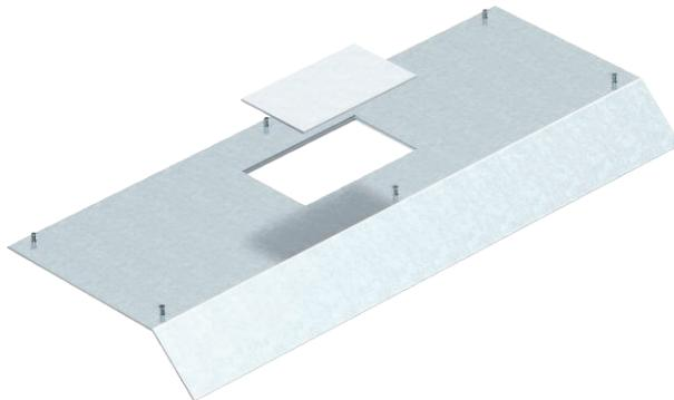
Geräteeinsatzdeckel für Kanalunterteil AIK/U für den Einbau eines Geräteeinsatzes der Nenngöße 2. Montageöffnung durch 2-mm-Alu-Blindplatte verschlossen. Der Kanaldeckel wird in den Al-Seitenprofilen des Kanalunterteils festgeschraubt. Die Deckelschräge überagt das Kanalunterteil im 45°-Winkel.
