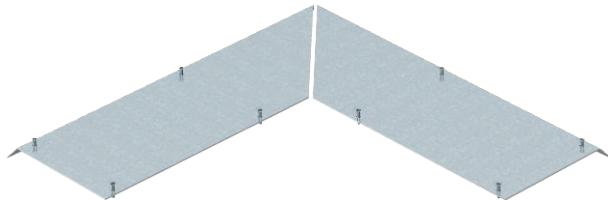
Blinddeckel 2-teilig zum Abdecken des Außenecks eines Aufbodenkanals, passend zu den Kanalunterteilen AIK/U inkl. 10 Befestigungsschrauben. Der Kanaldeckel wird in den Al-Seitenprofilen des Kanalunterteils festgeschraubt. Die Deckelschräge überragt das Kanalunterteil im 45°-Winkel.
