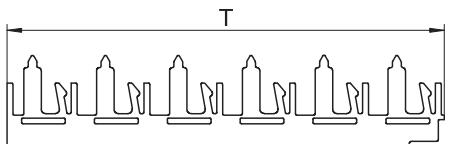
Profilverbinder horizontal mit Führungsschlitten zum Einrasten von Konvektionsgitterprofilen. Der Profilverbinder wird mit dem Spannbügel Typ SP3 auf der Befestigungskonsole montiert.
