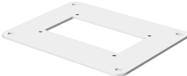
Bodenplatte mit 30 mm sichtbarem Rand und 4 Befestigungslöchern Ø 8,5 mm. Die Bodenplatte eignet sich zur Montage von Installationssäulen vom Typ ISS70110.
