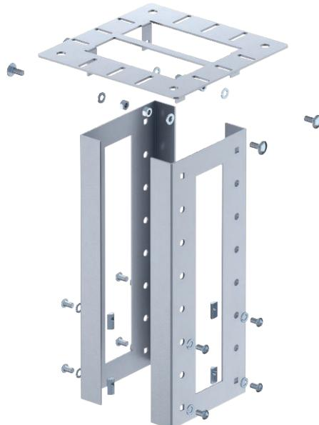
Deckenbefestigung zur Befestigung der ISS-Industriesäule an der Decke. Im Lieferumfang enthalten sind 2 U-förmige Profile aus 3 mm Stahlblech, die Befestigungsplatte für die Decke und das erforderliche Montagezubehör inkl. Nutenstein. Die Deckenbefestigung ist an dem Säulenprofil variabel höhenverstellbar.
