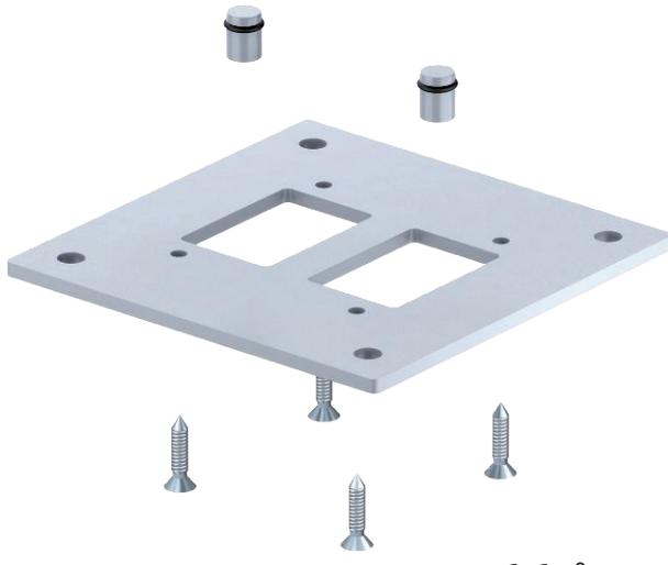
Bodenplatte zur Befestigung der ISS-Industriesäule auf dem Boden. Im Lieferumfang enthalten sind 4 Befestigungsschrauben zur Montage der Bodenplatte am Säulenprofil und 2 Dichtstopfen zum luftdichten Verschließen der Druckluftkanäle.
