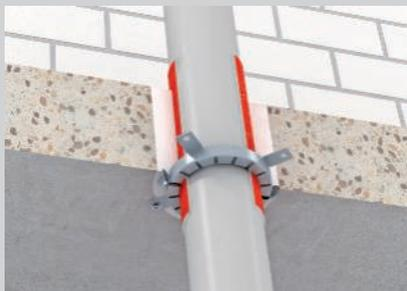
Montage an der Deckenunterseite mit Metalldübeln.
