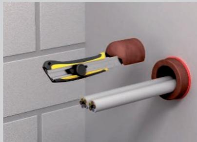
Zuschneiden und Einsetzen der Stopfen in die Rohrschale.
