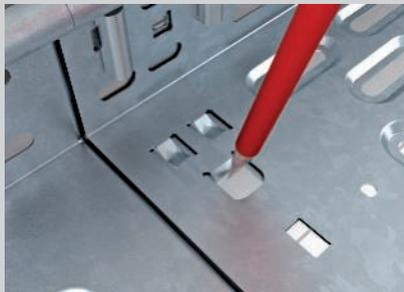
Umbiegen der Sicherungslaschen im Boden.
