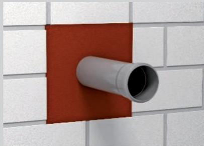
Brennbare Rohre bis Ø 50 mm ohne Zusatzmaßnahmen durchführbar.
