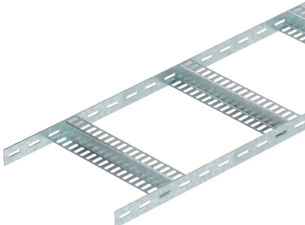
Schiffskabelleiter leichte Ausführung, mit gelochtem Seitenholm in der Seitenhöhe 35 mm mit eingeschweißten, gelochten Z-Sprossen. Belastung geprüft nach IEC in Kombination mit Verbinder Typ SLV.
