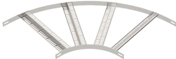
90° Bogen für Schiffsbau-Kabelleiter Typ SLZ L mit der Seitenhöhe 35 mm, mit eingeschweißten, gelochten Z-Sprossen.
