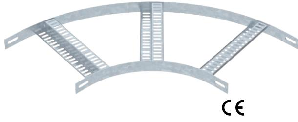
90° Bogen für Schiffsbau-Kabellleiter Typ SLZ L mit der Seitenhöhe 35 mm, mit eingeschweißten, gelochten Z-Sprossen.
