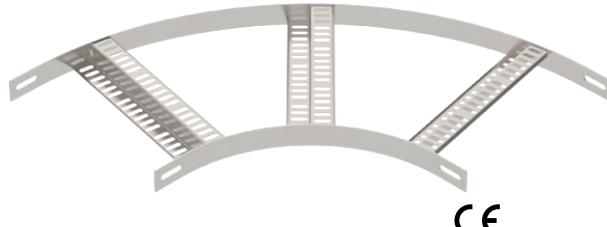
90° Bogen für Schiffsbau-Kabelleiter Typ SLZ L mit der Seitenhöhe 35 mm, mit eingeschweißten, gelochten Z-Sprossen.
