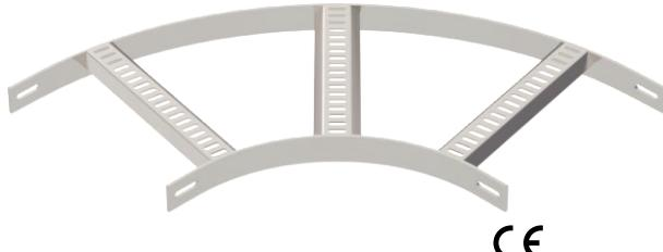
90° Bogen für Schiffsbau-Kabelleiter Typ SL 62 mit der Seitenhöhe 40 mm, mit eingeschweißten, nach unten offenen und gelochten Trapezsprossen.
