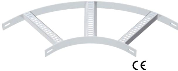
90° Bogen für Schiffsbau-Kabelleiter Typ SL 62 mit der Seitenhöhe 40 mm, mit eingeschweißten, nach unten offenen und gelochten Trapezsprossen.
