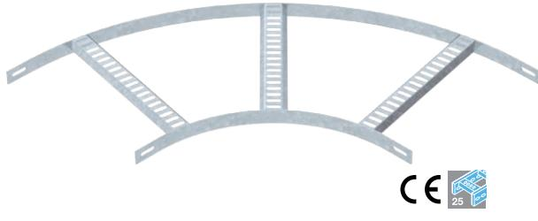
90° Bogen für Schiffsbau-Kabelleiter Typ SL 42 mit der Seitenhöhe 25 mm, mit eingeschweißten, nach unten offenen und gelochten Trapezsprossen.
