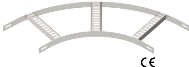
90° Bogen für Schiffsbau-Kabelleiter Typ SL 42 mit der Seitenhöhe 25 mm, mit eingeschweißten, nach unten offenen und gelochten Trapezsprossen.
