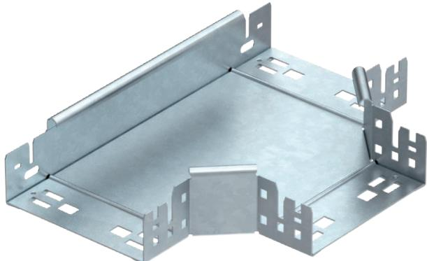
T-Abzweigstück mit Schnellverbindungs-System. Für alle Kabelrinnentypen mit der Seitenhöhe 60 mm.
