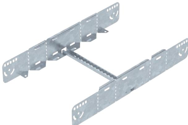
Multifunktionsverbinder zur Verbindung von Kabelleitern mit der Seitenhöhe 110 mm. Es können symmetrische und asymmetrische Reduzierungen, stufenlose Bögen von 0-60° und Anbauabzweige erstellt werden.
