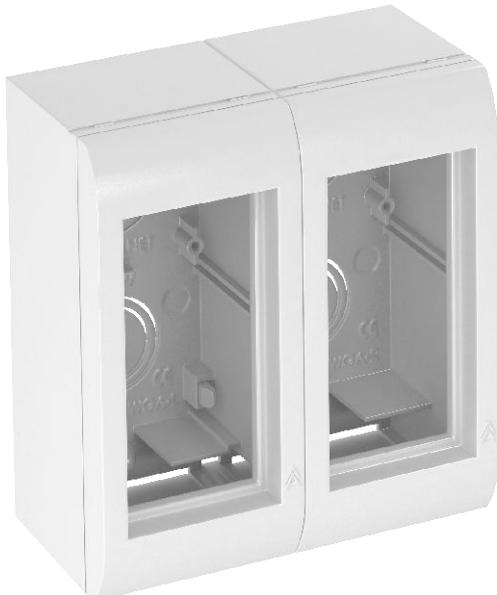
Basiskonfiguration bestehend aus 2 Gehäuseunterteilen (rechte und linke Seite) mit 2 Abdeckrahmen zur Aufnahme von Modul 45-Geräten in 2facher Modulbreite = 90mm.
