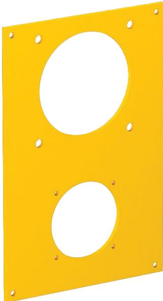
Abdeckplatte mit einer Ø 45-mm-Öffnung zum Einbau einer Anbausteckdose (Typ ASD...) mit 38-mm-Befestigungsspur und einer Ø 60-mm-Öffnung zum Einbau einer CEE-Steckdose 16/32 A mit 60-mm-Befestigungsspur, inklusiv 8 Schrauben zur Gerätebefestigung.
