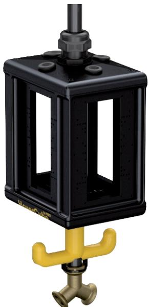
Leergehäuse mit 1 m Rohr 1/2" und Anschluss für Druckluftschlauch 13 x 3,5 mm und 2-Wege-Verteiler 1/2". Mit Aufhängeöse und Griffhaken, zum Einbau von elektrischen Betriebsmitteln, mit beigelegter Trennwand. Ohne Abdeckplatten. Zur Versorgung von Arbeitsplätzen in nassen Bereichen. Schutzgrad: IP 44.
