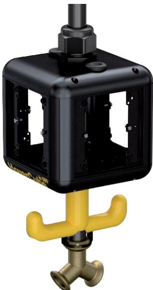
Leergehäuse mit 1 m Rohr 1/2" und Anschluss für Druckluftschauch 13 x 3,5 mm und 2-Wege-Verteiler 1/2". Mit Aufhängeöse und Griffhaken, zum Einbau von 4 elektrischen Betriebsmitteln, mit beigelegter Trennwand. Ohne Abdeckplatten.
