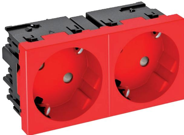
Schutzkontakt-Steckdose mit seitlichem Anschluss 2-fach 33°, mit erhöhtem Berührungsenschutz, mit Steckklemmen, 2-polig, 16 A, 250 V~, mit Verbindungsstellen nach IEC 60884-1.
