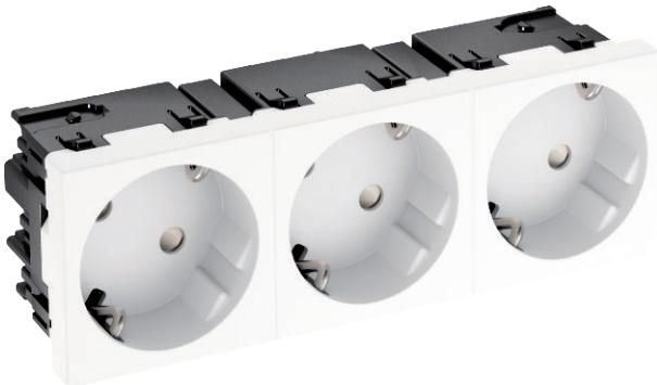
Schutzkontakt-Steckdose mit seitlichem Anschluss 3-fach 33°, mit erhöhtem Berührungsschutz, mit Steckklemmen, 2-polig, 16 A, 250 V~, mit Verbindungsstellen nach IEC 60884-1.
