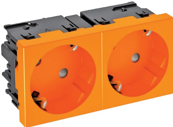
Schutzkontakt-Steckdose mit seitlichem Anschluss 2-fach 33°, mit erhöhtem Berührungsschutz, mit Steckklemmen, 2-polig, 16 A, 250 V~, mit Verbindungsstellen nach IEC 60884-1.
