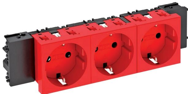
Schutzkontakt-Steckdose mit seitlichem Anschluss 3-fach 0°, mit erhöhtem Berührungsschutz, mit Steckklemmen, 2-polig, 16 A, 250 V~, mit Verbindungsklemmen nach IEC 60884-1, geeignet für den Einbau in Geräteeinbau-Kanalsysteme Rapid 45.
