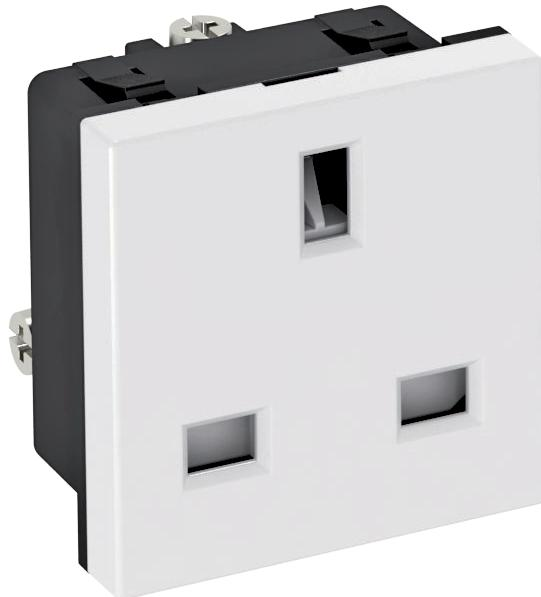
Steckdose 1-fach 0°, British Standard, konform zu BS 1363, mit erhöhtem Berührungsschutz, mit Schraubklemmen, 2-polig, 13 A, 250 V~.
