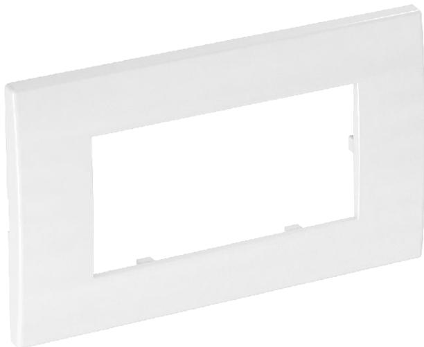
Frontrastender Abdeckrahmen für Modul 45 Einbaugeräte, 2fach, ohne Beschriftungsfeld für waagerechte und senkrechte Geräteinstallation, zum Rasten in Geräteeinbaudose 71GD13 oder in Montageträger 71MT2 45.
