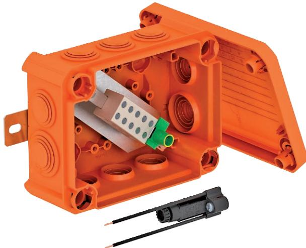
Halogenfreier Kabelabzweigkasten mit vormontierten, weichen Einstektdichtungen, zugelassen für den elektrischen Funktionserhalt gemäß DIN 4102 Teil 12. Funktionserhaltklassen E30 bis E90.
