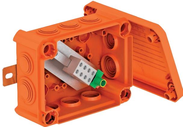
Halogenfreier Kabelabzweigkasten mit vormontierten, weichen Einstektdichtungen, zugelassen für den elektrischen Funktionserhalt gemäß DIN 4102 Teil 12. Funktionserhaltklassen E30 bis E90.
