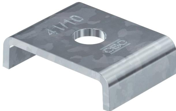
Bauteil zur Montage von Gewindestangen an Montageschienen MS4141P und MS4121P. Zur Montage von Kabelrinnen- und Gitterrinnensystemen oberhalb abgehängter Brandschutzdecken in Flucht- und Rettungswegen. Verhindert im Brandfall das Aufbiegen der Montageschienen. Geeignet für Gewindestangen M8, M10 und M12. Keine zusätzliche Unterlegscheibe notwendig.
