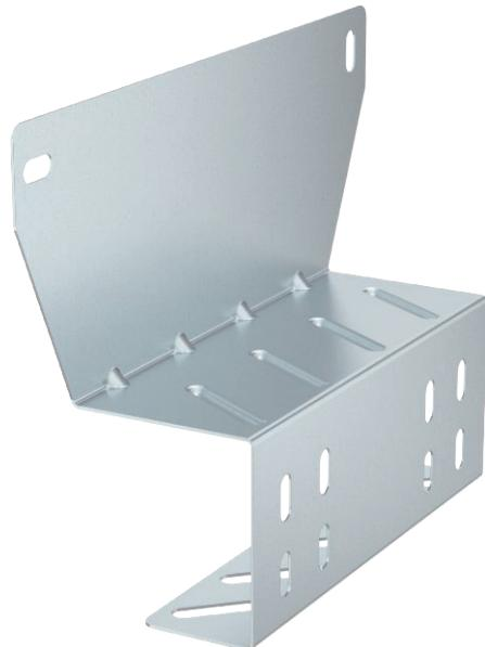
Montageplatte zur Befestigung von Kabelabzweigkästen der FireBox T-Serie (mit Außenbefestigung) an Kabelrinnen bzw. -leitern mit einer Seitenhöhe von 60 mm. Die abgewinkelte Bauform aus durch Sicken verstärktem Stahlblech ermöglicht die sichere Montage der Funktionserhaltkabel, ohne das Kabel über den Seitenholm biegen zu müssen.
