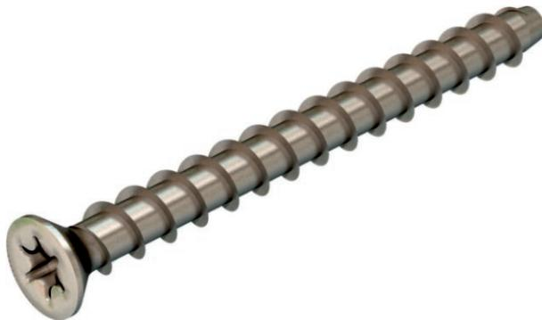
Brandschutz-Schraubanker mit Kegel-Senkkopf zur Montage ohne Dübel. Antrieb T20, Bohrloch 4 mm. Brandschutztechnisch geprüft gemäß DIN 4102 für Beton und Mauerwerk. Feuerwiderstandsklasse bis F90.
