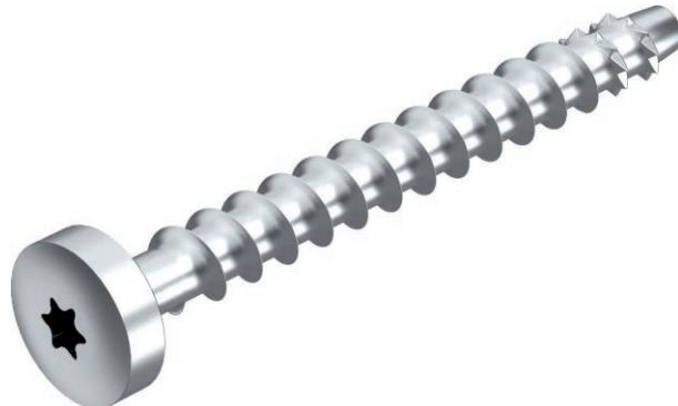
Brandschutz-Schraubanker mit Panhead zur direkten Montage ohne Dübel. Antrieb T30, Bohrloch 6 mm. Geprüfter Dübel gemäß ETAG 001 - Teil 3. Feuerwiderstandsklasse bis R120 für Beton und Mauerwerk.
