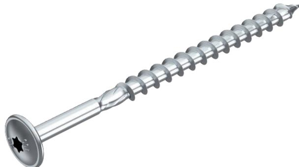
Selbstbohrende Holzschraube zur brandsicheren Befestigung von Kabelanlagen für den Funktionserhalt nach DIN 4102 Teil 12 an tragenden Holzbauteilen. Die Tellerkopfform ermöglicht den Einbau ohne zusätzliche Unterlegscheibe.
