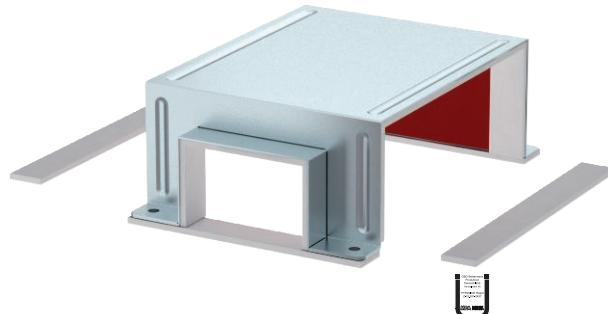
Haube zur Abdeckung einer T-förmigen Anordnung von drei zueinander laufenden Kanalenden. Gerade Strecke zweimal BSKM 1025, Abzweig reduziert auf BSKM 0711. Inklusive eingeklebter Dichtungen zum Abdichten der Fugen und losen Dichtungen bei Kombination mit Gegenplatte, sowie Schrauben für den Potentialausgleich.
