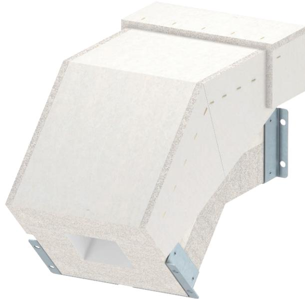
Vertikalbogen 45° in fallender Ausführung für Brandschutzkanal BSKHF-0808 bestehend aus wasser- und frostbeständigen Glasfaserleichtbeton der Baustoffklasse A1 gemäß EN 13501 Teil 1, zur Installation auf OBO-Montagesystemen. Inklusive fertig montierter Verbinder an beiden Kanalenden, Verbindungsschrauben und Dichtungsstreifen. Formteile müssen durch zusätzliche Ausleger unterstützt werden.
