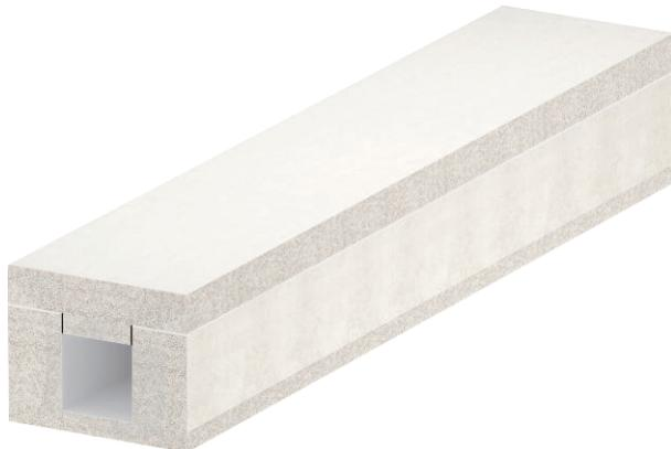
Brandschutzkanal für die direkte Wand- und Deckenmontage bestehend aus wasser- und frostbeständigen Glasfaserleichtbeton der Baustoffklasse A1 gemäß EN 13501 Teil 1 zur brandsicheren Verlegung von Lichtwellenleiter-Kabel (LWL) gemäß Funktionserhalt nach DIN 4102 Teil 12, klassifiziert für E30 und E90. Inklusive 10 Senkkopfschrauben und 3 x 1 m Dichtungsstreifen.
