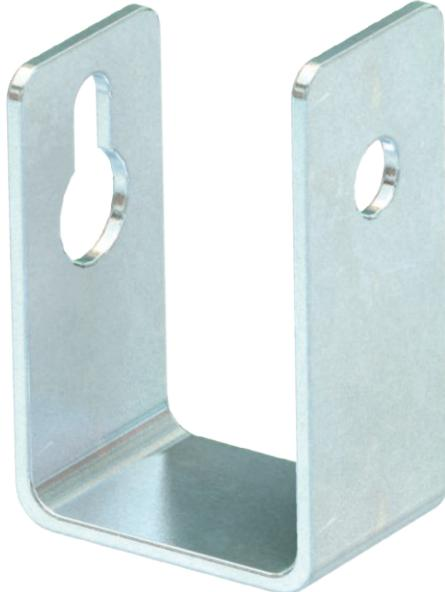
Trennwinkel als Installationshilfe bei Wandmontage des Brandschutzkanals PYROLINE® Con D BSK, Typ BSK 090511 und Typ BSK 120511. Montage des Winkels direkt an den Befestigungsdübeln des Brandschutzkanals.
