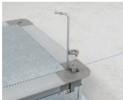
Aufstockhilfe montieren Verriegelungsdeckel lösen und Schrauben leicht herausdrehen. Eine Schnellriegelungshilfe einstecken und Schraube herausheben.
