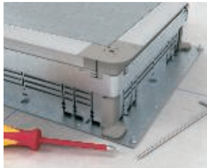
Einstellung der Dosenhöhe Unterflurdosen haben eine Mindestbauhöhe von 70 mm und einen Nivellierbereich von +55 mm. Differenzen zwischen Dosenbauhöhe und Estrichsollhöhe lassen sich entweder über Nivellierschrauben oder durch die Schnellriegelungshilfe ausgleichen.
